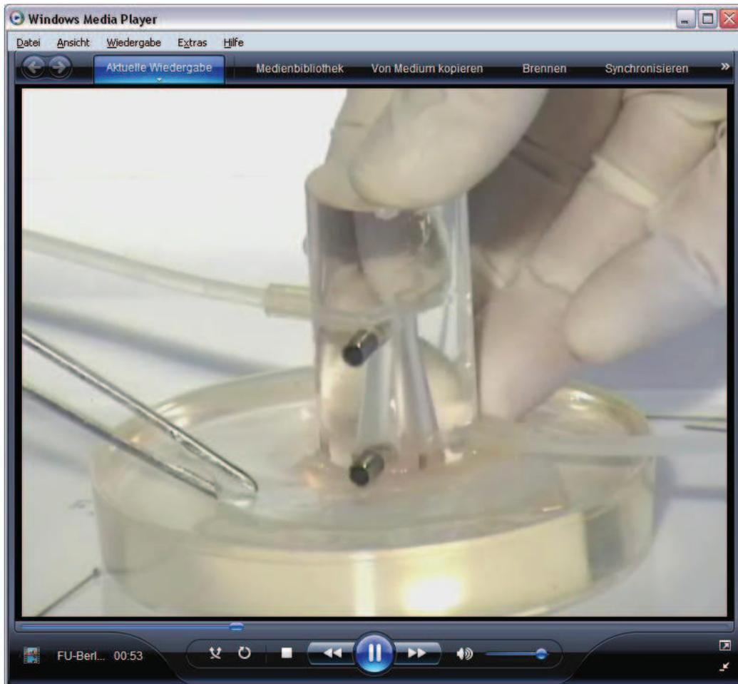
*Abb. 2: Ussingkammer-Zusammenbau*
